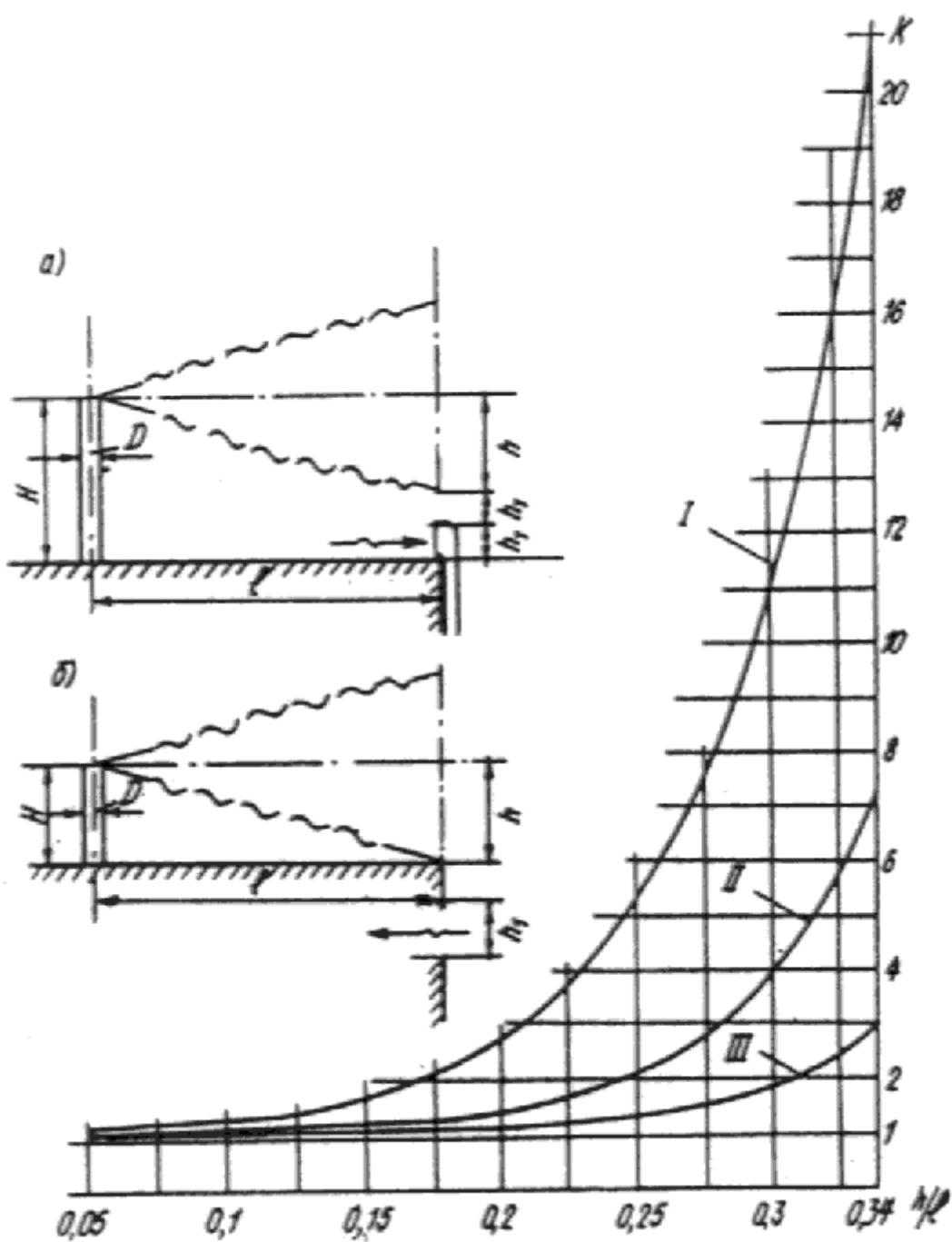
*a* - расположение источника над зоной всасывания наружного воздуха приемным устройством (высота трубы источника  $H = 2h_1 + h$ );
