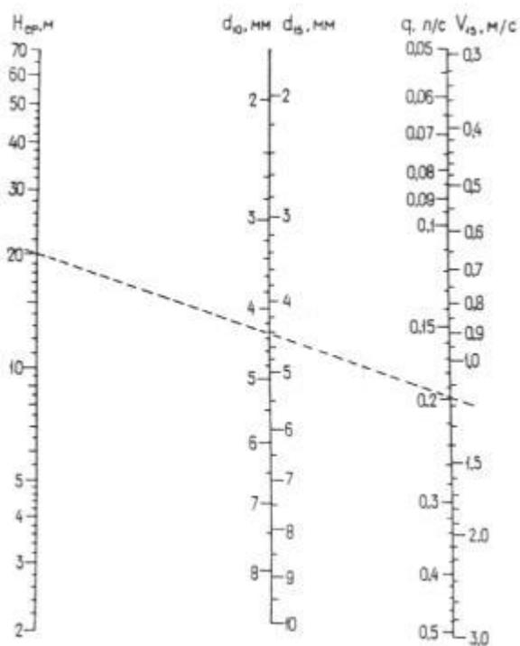
Черт. 6. Номограмма для определения диаметров отверстий диафрагм,
